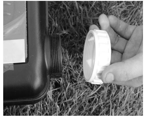
3. Placez les joints toriques sur le côté court de chacun des Adaptateurs pour tuyaux et insérez ce même côté dans les ouvertures IN (ENTRÉE) et OUT (SORTIE) du Chauffe-eau solaire. Attachez les Raccords CPV sur les Adaptateurs pour tuyaux et serrez pour fixer solidement.
