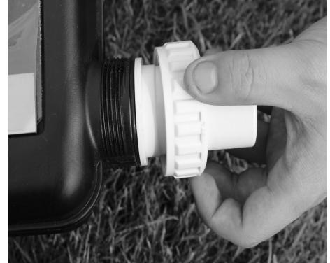
4. Conecte los ajustes de retorno desde adentro de la piscina para asegurarse que el agua no fluya fuera de la piscina cuando se desconecta la manguera de retorno de la entrada de retorno de la piscina en los siguientes pasos.
