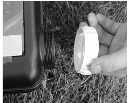
3. Coloque las juntas tóricas en el lado corto de cada adaptador de manguera e inserte el mismo lado en las aberturas IN y OUT del calentador solar. Una los acoplos de PVC en los adaptadores de la manguera y ajústelos para que queden seguros.
